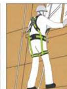
Descente en double corde
